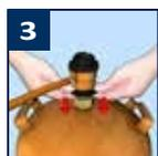
3 Coloca el regulador sobre la válvula de la bombona. Presiona el anillo hacia abajo y escucharás un "clic", señal de que está bien encajado. Asegúrate tirando del cuerpo del regulador hacia arriba.
