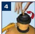
4 Para abrir el paso del gas, levanta la palanca del regulador hasta que quede visible la llama que lleva grabada.
