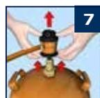
7 Desacoplamiento del regulador. Levanta el anillo negro con ambas manos y sepáralo de la bombona.
